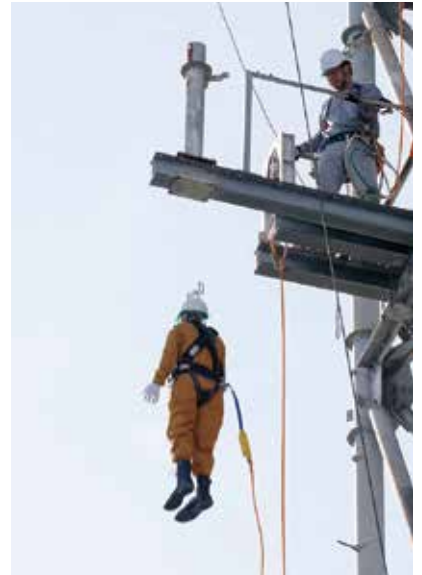
在试验铁塔上进行坠落实验
